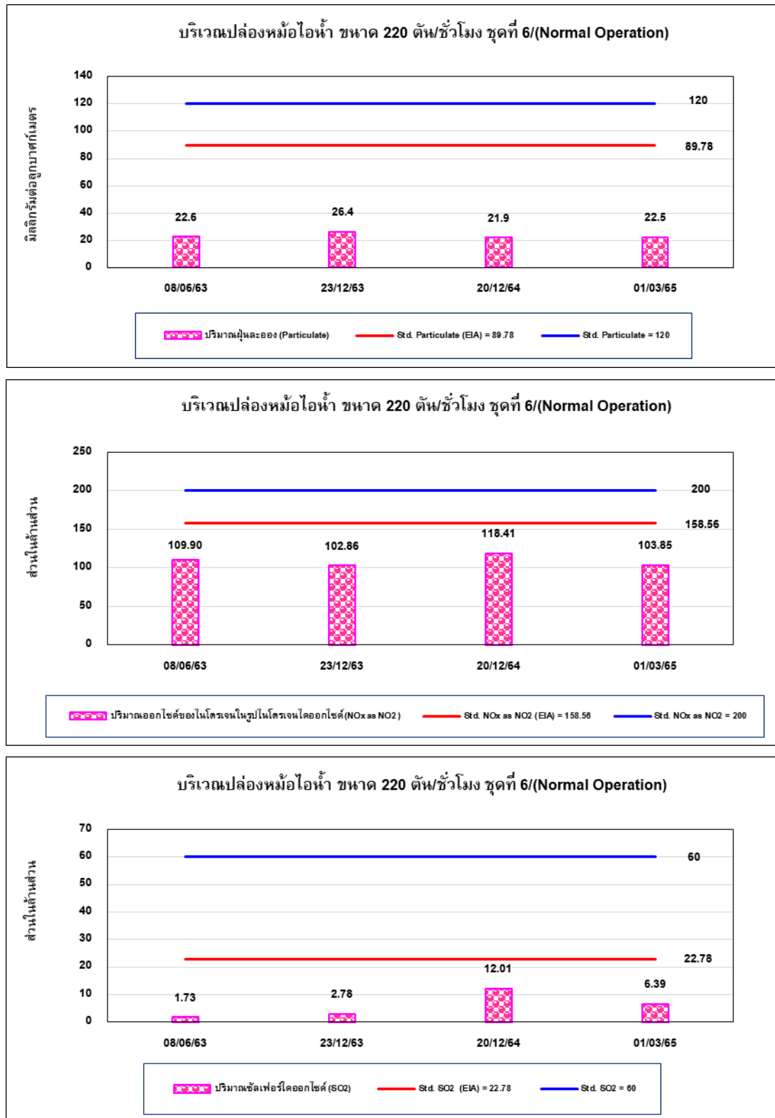
รูปที่ 4.1-1 (ต่อ) กราฟเปรียบเทียบผลการตรวจวัดคุณภาพอากาศจากปล่องระบาย ระหว่างปี 2563-2565
